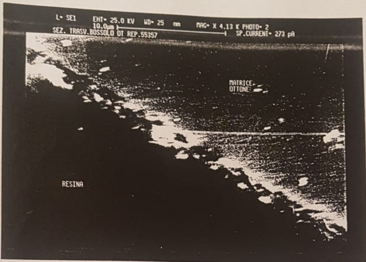
Fig. 30- Micrografia S.E.M. del bossolo reperto 55357 in sezione trasversale. Si noti la zona del deposito spugnoso di rame causato dal processo di dezincificazione. X 4130 Neg. 011920/S
