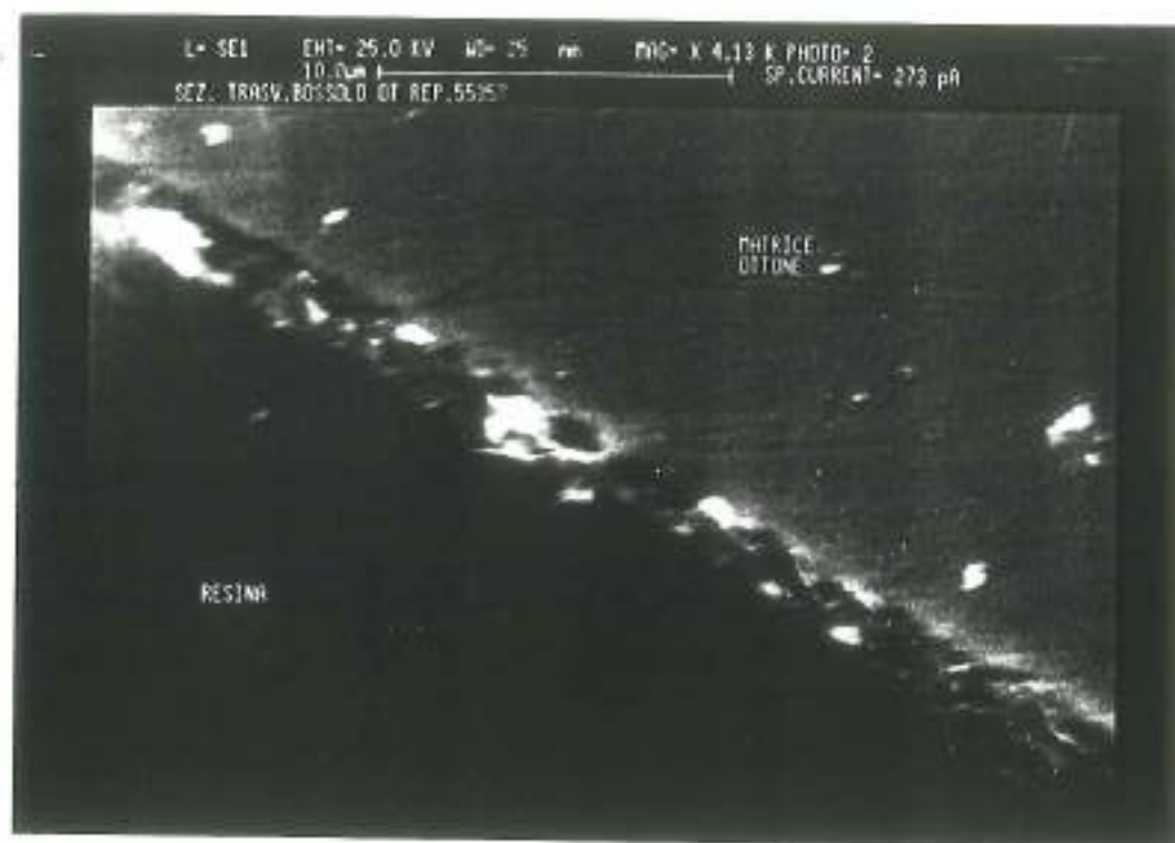
Fig. 30- Micrografia S.E.M. del bossolo reperto 55357 in sezione trasversale. Si noti la zona del deposito spugnoso di rame causato dal processo di dezincificazione. X 4130 Neg. 011920/S
