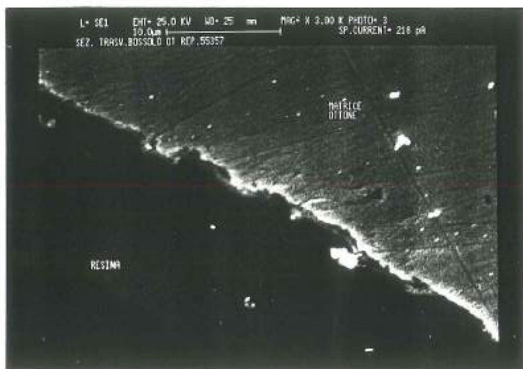
Fig. 31- Micrografia S.E.M. del bossolo reperto 55357 in sezione trasversale. Si noti la zona del deposito spugnoso di rame causato dal processo di dezincificazione più esigua di quella riscontrata in fig. 30. X 3000 Neg. 011921/S
