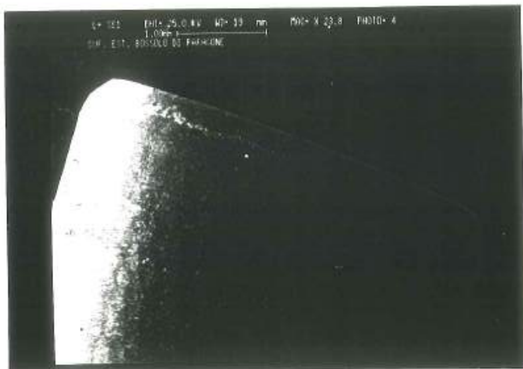
Fig. 27- Micrografia S.E.M. del bossolo "confronto" . Si noti la morfologia della zona di aggraffatura dell'ogiva di piombo. X 23,8 Neg. 011730/S
